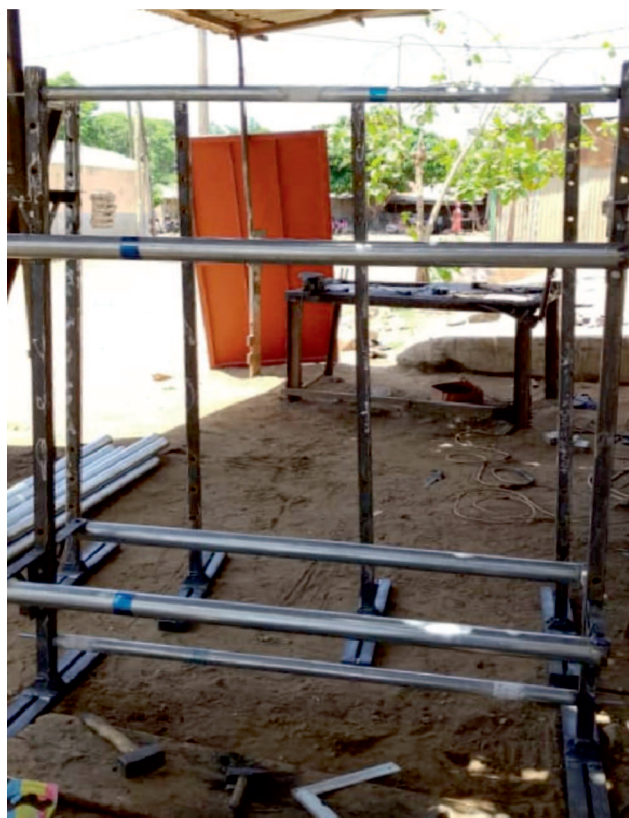
Lokpo-Webstuhl im Rohbau
