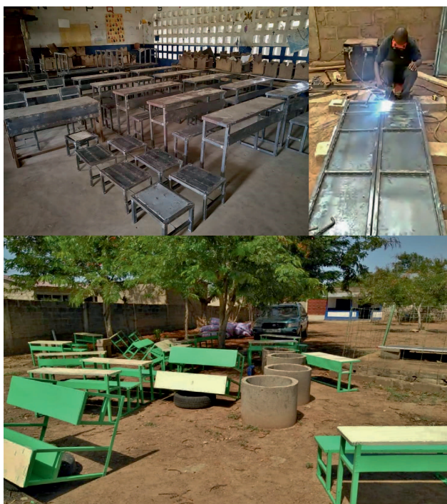
Schulmobiliar aus Metall wird hergestellt (Holz verzieht sich im Savannenklima stark)
